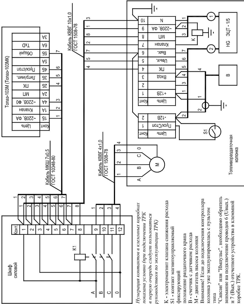
Нумерация контактов в клеммных коробках показана условно (при подключении ТРК в первую очередь следует пользоваться руководством по эксплуатации ТРК)
