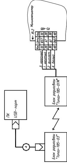
Рис. 1.3. Схема электрическая подключения миникомпьютера к ПК через блоки радиосвязи серии "Топаз-185".
