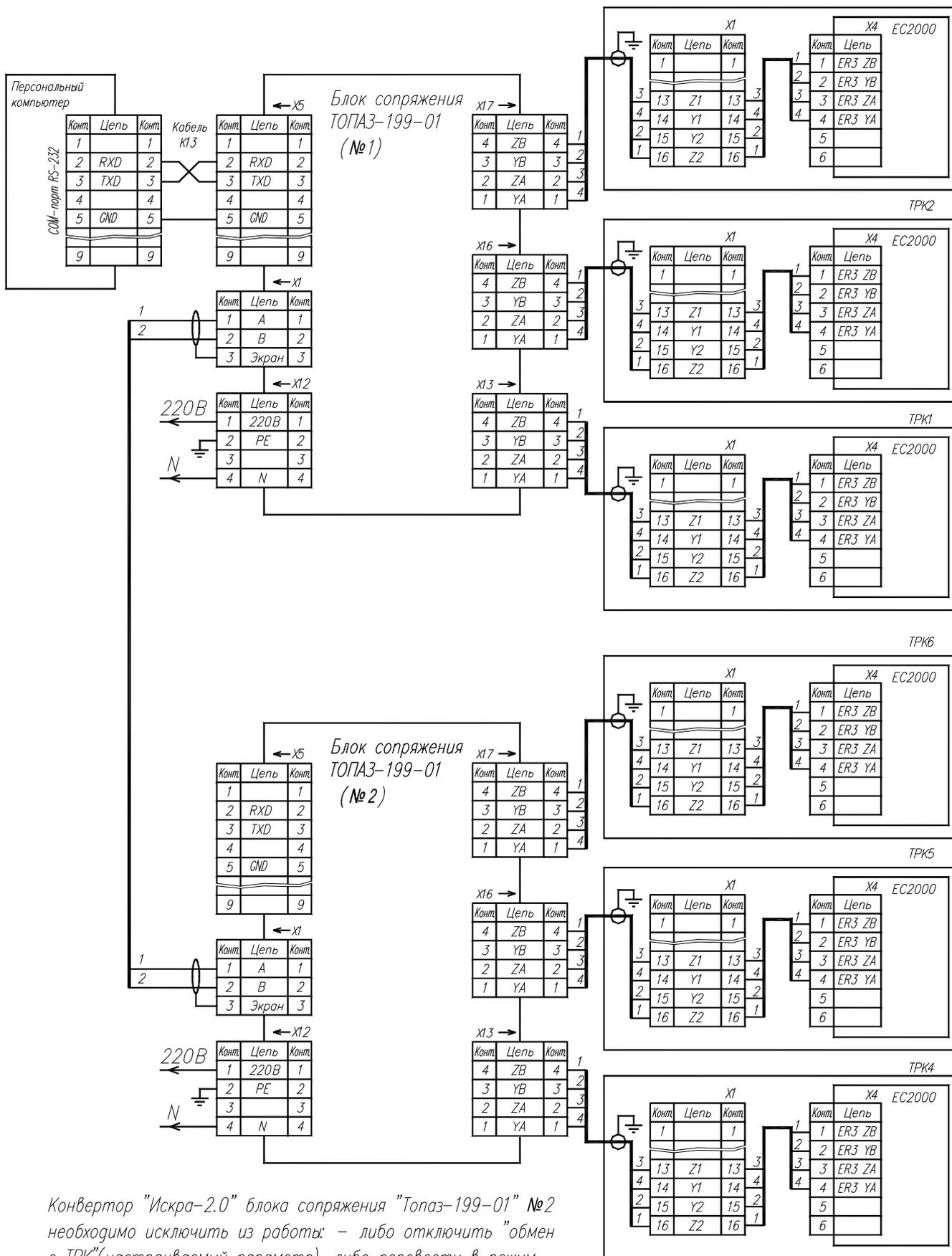
Конвертор "Искра-2.0" блока сопряжения "Топаз-199-01" №2 необходимо исключить из работы: - либо отключить "обмен с ТРК"(настраиваемый параметр), либо перевести в режим "преобразование интерфейсов".
