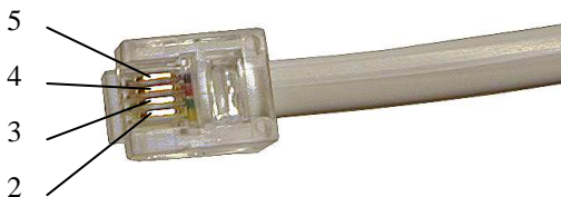
Нумерация контактов вилки 6Р4С (контакты 1 и 6 отсутствуют)
