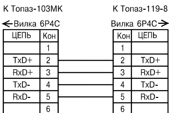
Схема кабеля K5
