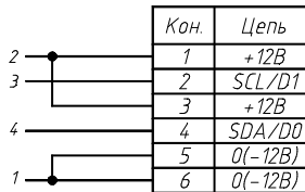
Схема кабеля 1 Розетка IDC-06F
