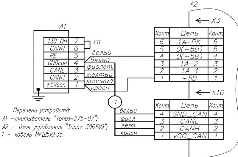
Рис. 2. Подключение счетчика к блоку управления "Топаз-306БУ16"
