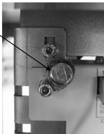
Рисунок Б.7 – Схема пломбировки узлов крепления БУ
