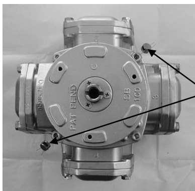
Рисунок Б.2 – Схема пломбировки измерителей объема ЖМТ
